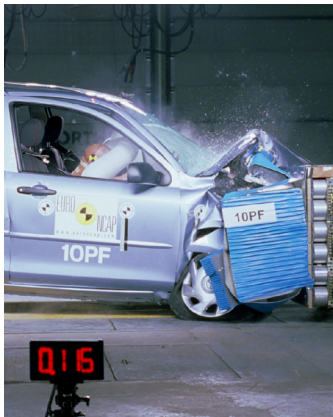
Obrázek 5-1. Fotografie „crash testu“ neboli nárazové zkoušky automobilu.
